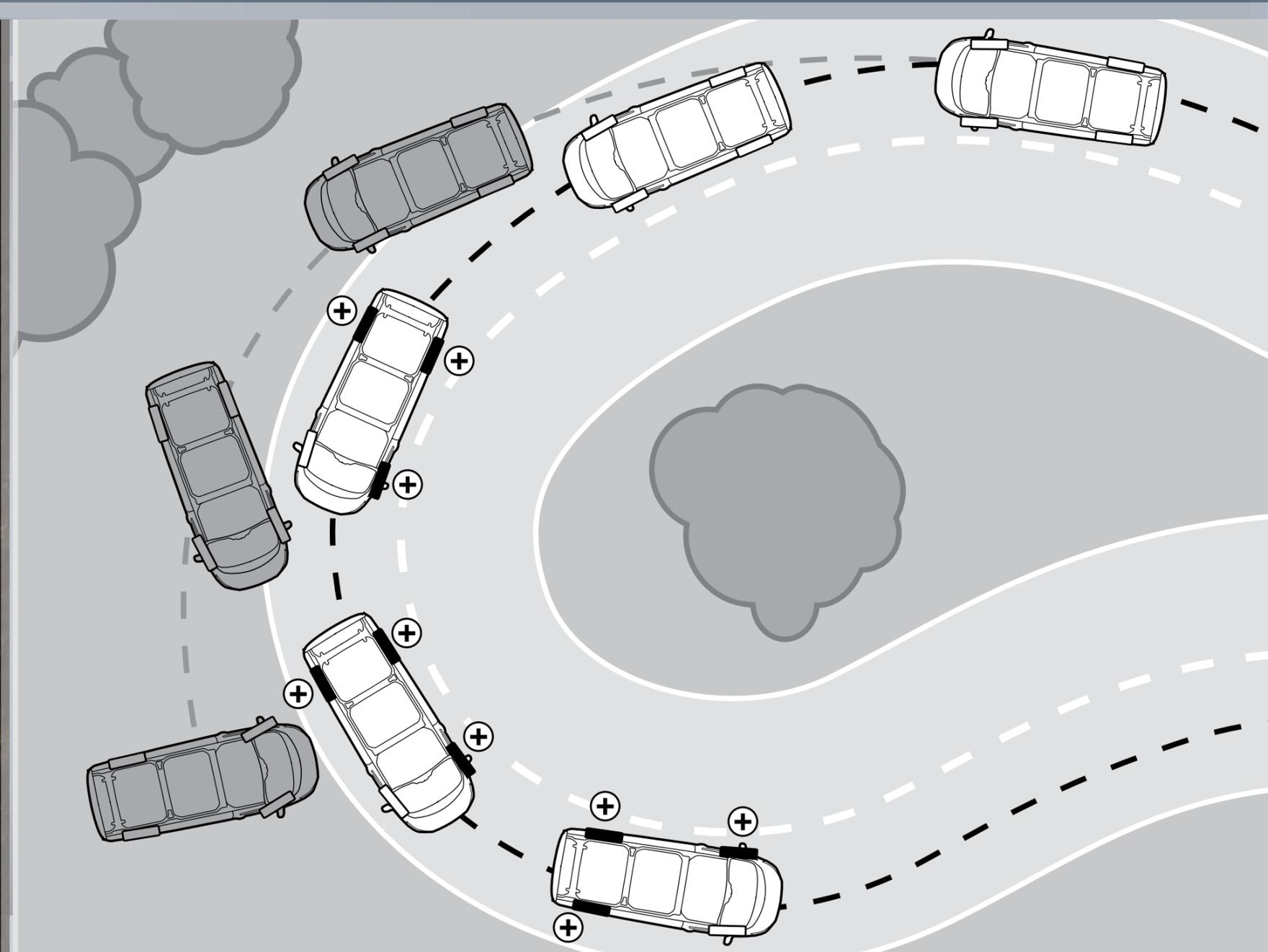
Este sistema monitorea de forma continua la trayectoria del vehículo a través de sensores de velocidad ubicados en las ruedas delanteras y traseras, y la compara con el recorrido deseado por el conductor.
