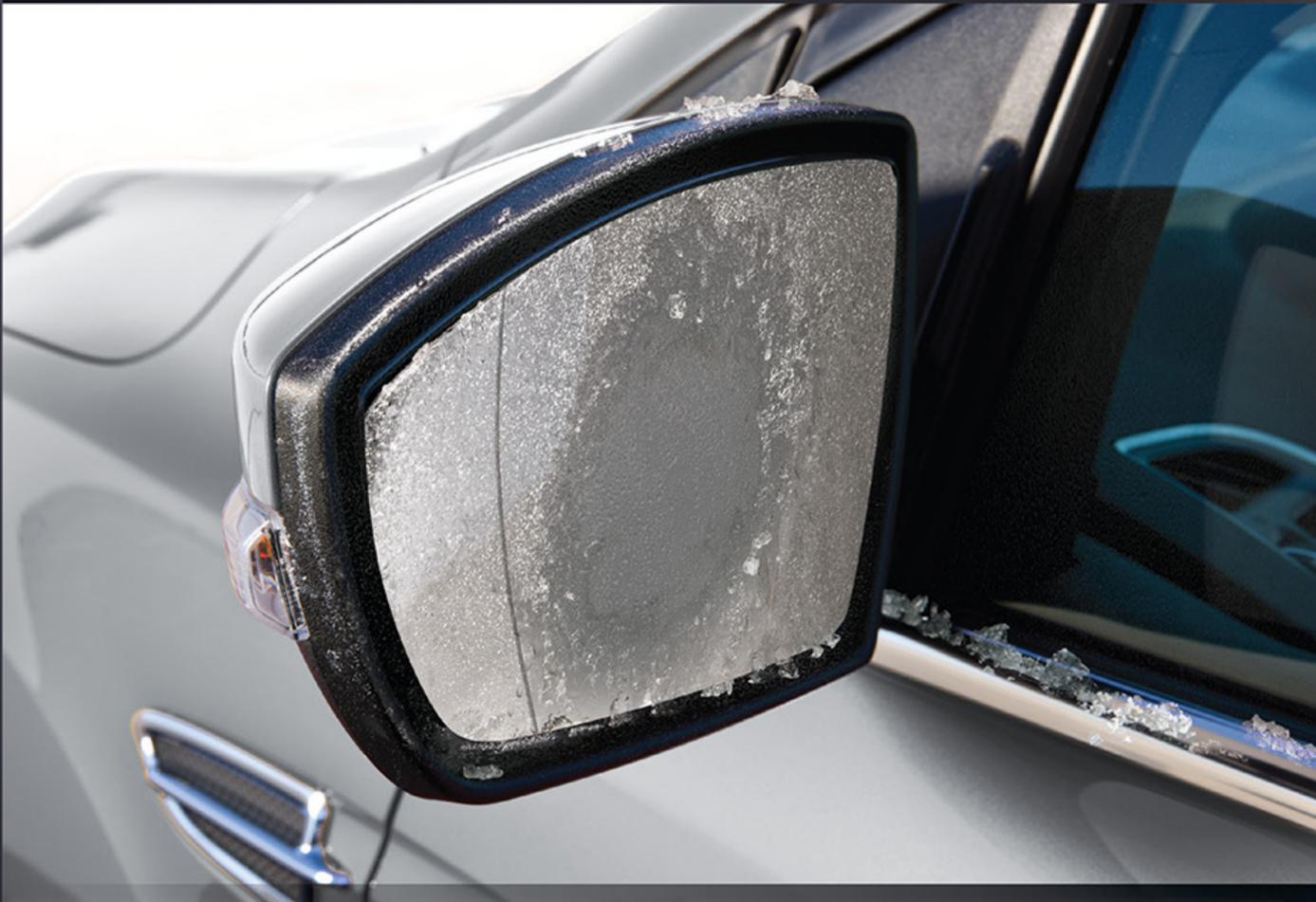
Los espejos exteriores con regulación eléctrica están calefaccionados y se pliegan automáticamente (versión Titanium).
