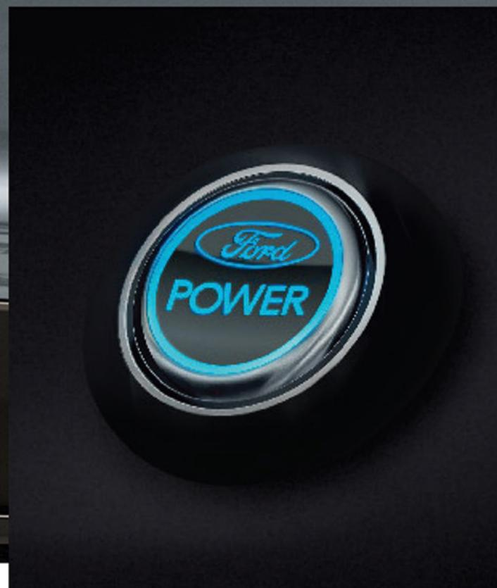
Cuenta también con el sistema de arranque sin llave mediante el botón Ford Power. Cuando el conductor ingresa al vehículo con el control remoto, las antenas internas detectan su presencia y el sistema le permite optar entre contacto, encendido y apagado del motor mediante este botón dispuesto en la parte superior de la consola central, junto al volante.
