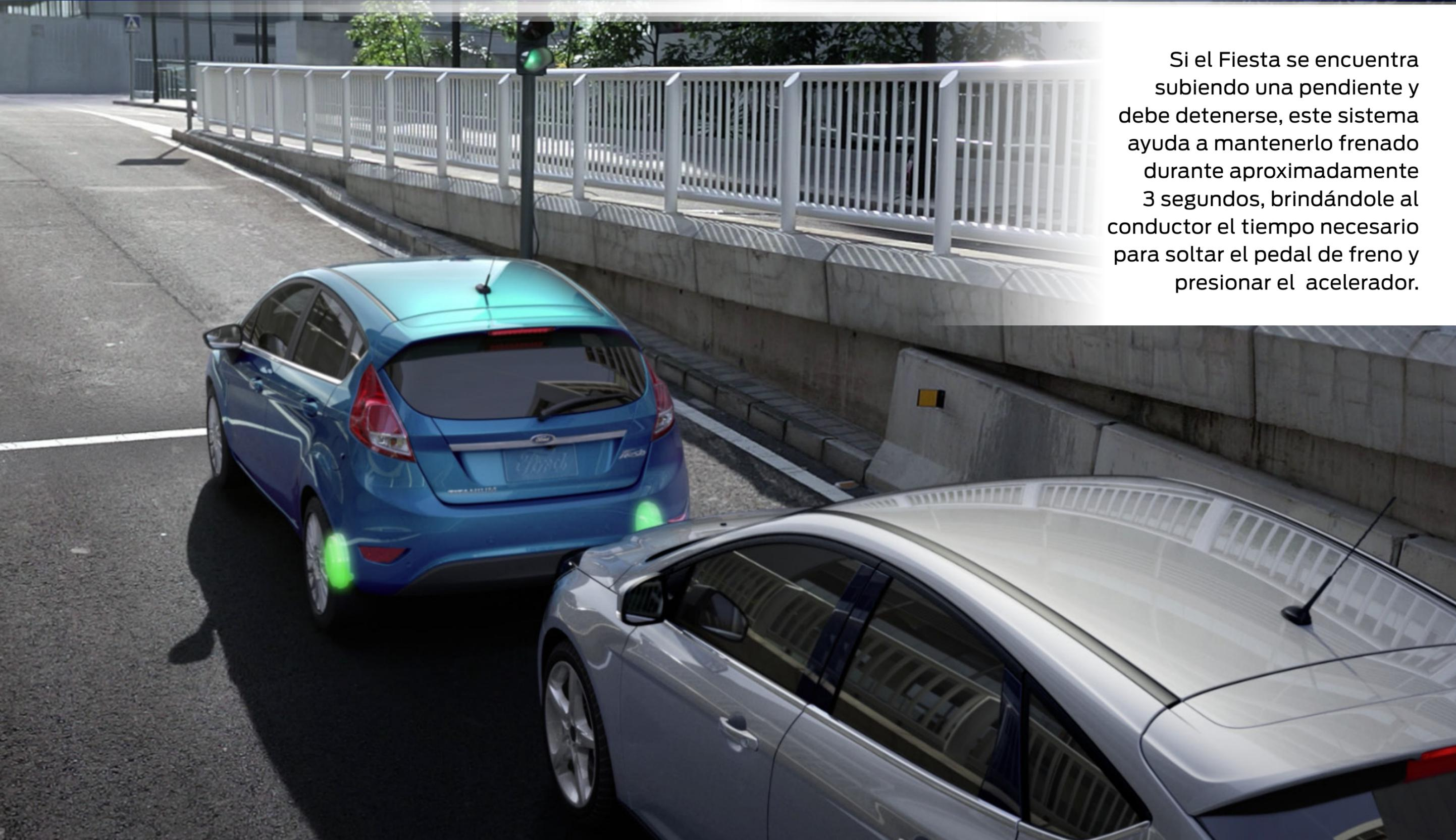
Si el Fiesta se encuentra subiendo una pendiente y debe detenerse, este sistema ayuda a mantenerlo frenado durante aproximadamente 3 segundos, brindándole al conductor el tiempo necesario para soltar el pedal de freno y presionar el acelerador.
