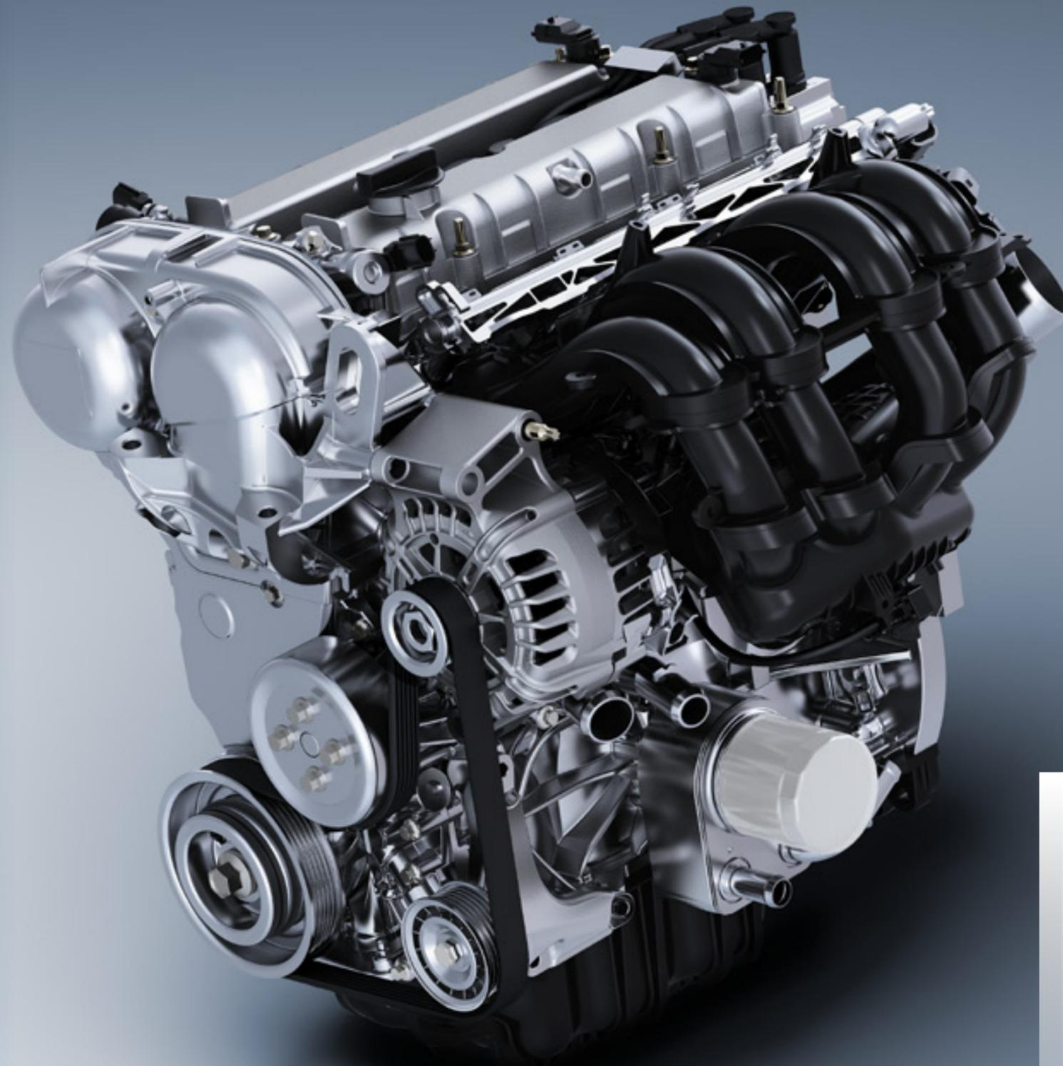
EL MOTOR DEL FIESTA CUENTA CON DOBLE ÁRBOL DE LEVAS Y OFRECE 120 CV DE POTENCIA A 6.000 RPM.
